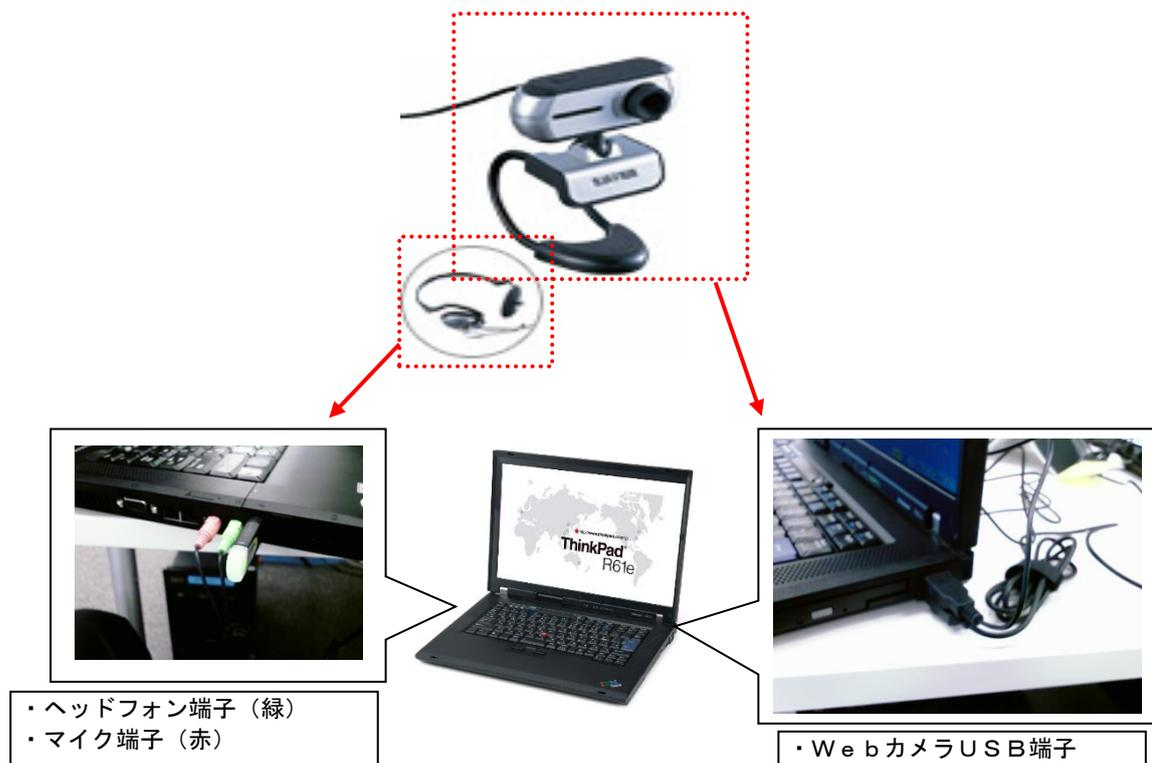
図3-1 Webカメラ・ヘッドフォンのPCへの接続
